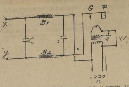
Hay muchos radio aficionados que en sus deseos de fabricarse un transmisor pequeño, se ven en la imposibilidad de hacerlo, porque no disponen de una fuente de energía capaz de abastecer la placa del tubo oscilador, por cuanto sólo cuentan de la red de alumbrado de corriente alterna a 220 volts y 50 ciclos, lo que no sirve para modular la voz.
