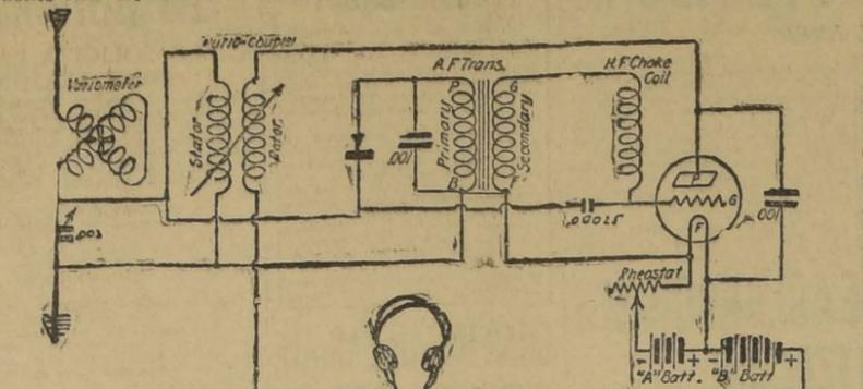
de cobre con doble capa de algodón, nom. 22, de seis décimas. 1 transformador de audio frecuencia (baja). Relación 6:1. 1 detector a galena, fijo o no. 1 bobina homocomb de 100 espiras. 2 condensadores fijos de .001 mfd.
