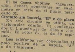
Circuito sin batería "B" o de placa. En este circuito se utiliza un variocoupler común...
