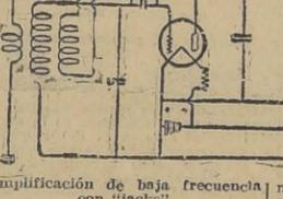
Amplificación de baja frecuencia con "jacks"...
