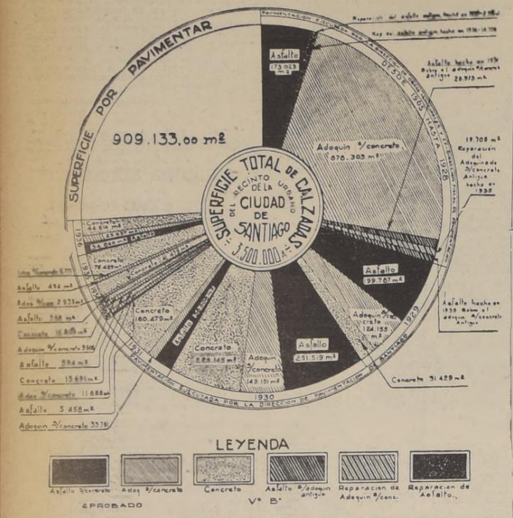
Gráfico que muestra el avance global de la pavimentación de la ciudad, con anterioridad al año 1936. Lo construido anualmente por la Dirección de Pavimentación de Santiago, entre los años 1933 y 1936 y la superficie por pavimentar.
