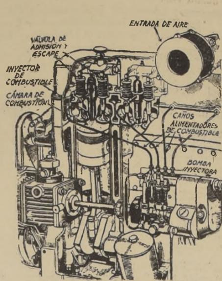
Corte de un motor Diesel típico.
