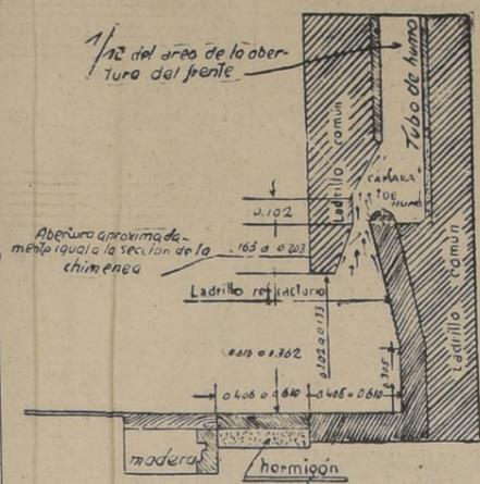
Sección esquemática de una chimenea bien construida.
