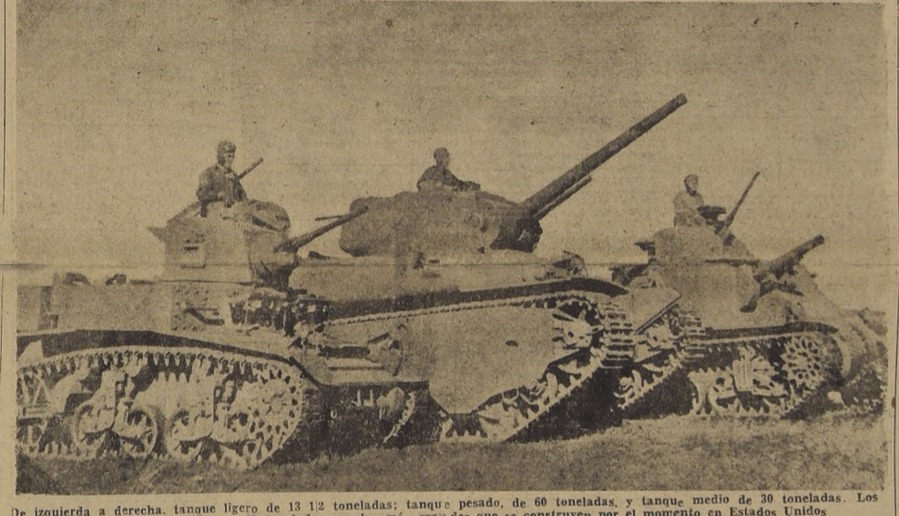
De izquierda a derecha, tanque ligero de 13 toneladas; tanque pesado, de 60 toneladas; y tanque medio de 30 toneladas. Los Carros de asalto de 60 toneladas son los más grandes que se construyen por el momento en Estados Unidos.
