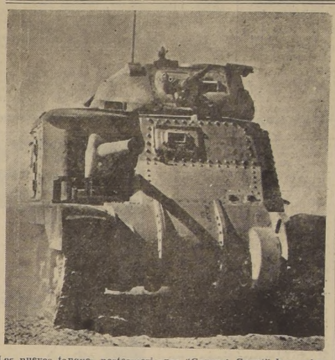
Los nuevos tanques norteamericanos "General Grant" han sobresalido en la nueva ofensiva aliada en el frente del desierto. Armados con un cañón de 37 mm. y con otro de 75 mm., y poderosamente blindados, han hecho estragos entre las divisiones panzer del enemigo.
