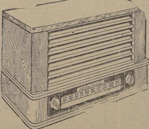
Receptor de fabricación norteamericana. 5 tubos, ondas larga y corta, corriente universal. Gabinete de madera enchapada en varios colores.
