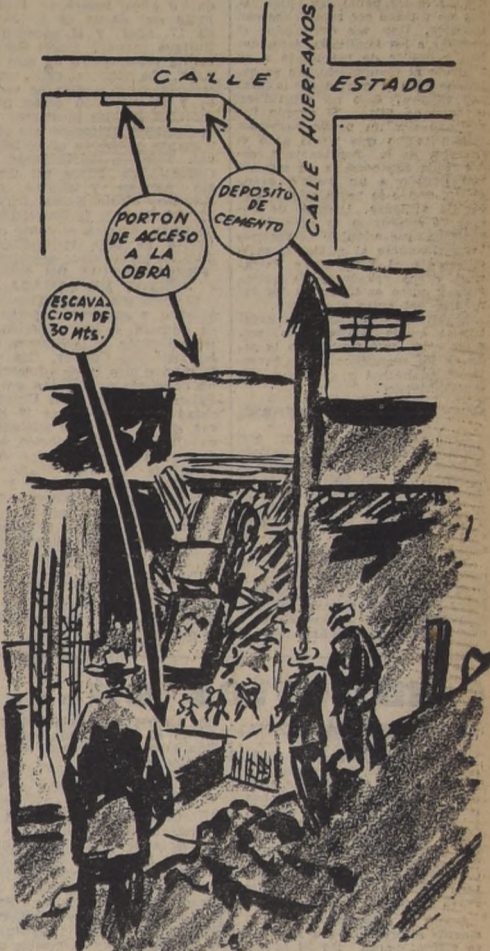
El croquis da una idea de la forma en que se produjo el trágico derrumbe de Huérfanos y Estado. El depósito de cemento debió ser rápidamente vaciado, a fin de impedir un nuevo deslizamiento de tierra que habría sido catastrófico, ya que bajo la barraca trabajaba el grueso de las cuadrillas de obreros en el rescate de las víctimas. Por el portón de acceso a la obra cayó el camión, yendo a estrellarse en un enorme bloque de concreto que formaba el muro de contención que sostenía la plataforma de descarga
