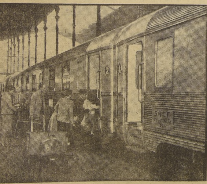
VAGONES SEGUROS. — Estos vagones franceses, de acero inoxidable, 33 toneladas de carga, tienen altas características mecánicas. Ellos dan una notable seguridad a los pasajeros. En Chile podríamos contar con estos vagones, siempre que fructifiquen las gestiones de Monsieur Marcel Tissier, ingeniero jefe de los Ferrocarriles franceses, quien se encuentra entre nosotros.
