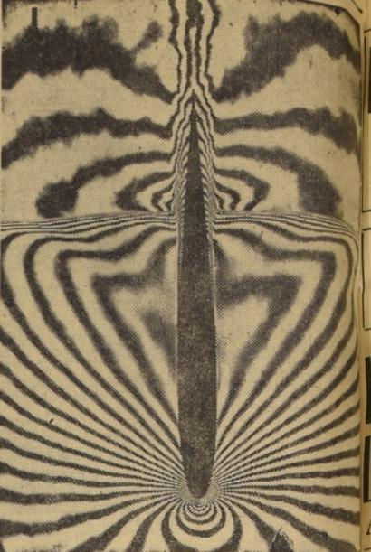
UN MILLONÉSIMO DE SEGUNDO.— La cámara fotográfica captó este diseño, perfectamente simétrico, del aire en torno a un modelo aéreo, en un túnel de viento, a velocidad de 150 metros por segundo. La fotografía se obtuvo en el Laboratorio Nacional de Física de Gran Bretaña. — (Foto Bippa).
