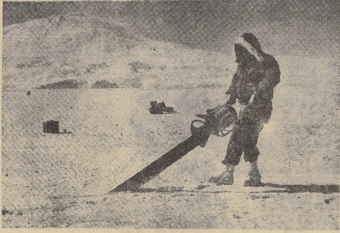
EL ESPESOR DEL HIELO para la pista de aterrizaje en "McMurdo Sound", es probado mediante una sierra motorizada a cadena de 7 pies de largo.
