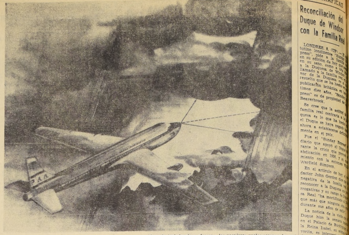
Día y noche en pleno vuelo el equipo de radar lanza al espacio en forma de abanico— 24.000 ondas por minuto con una potencia de 40.000 vatios. Estas ondas reflejan en la pantalla de la cabina de mando cuando encuentran en el espacio en todo su radio de acción. Gracias al radar los pilotos pueden evadir cualquier
