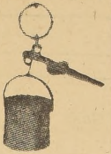
Fig. 2.— Comprobador de peso por volumen (litro por kg.). Determina el contenido de materias extrañas.
