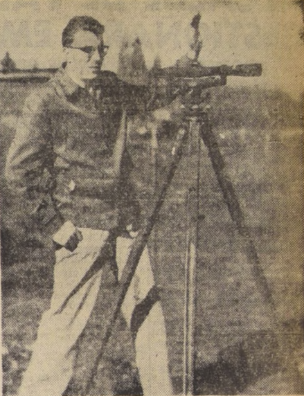
El Ingeniero Agrónomo, señor Carlos Crovetto, maneja el nivel con el fin de levantar un mapa topográfico para nivelación de tierra y ubicar posteriormente allí un ranque. La fotografía fue tomada en el rancho de J. E. Spencer, ubicado en Fruitridge, en el Distrito de Conservación de Suelos del Condado de El Dorado.
