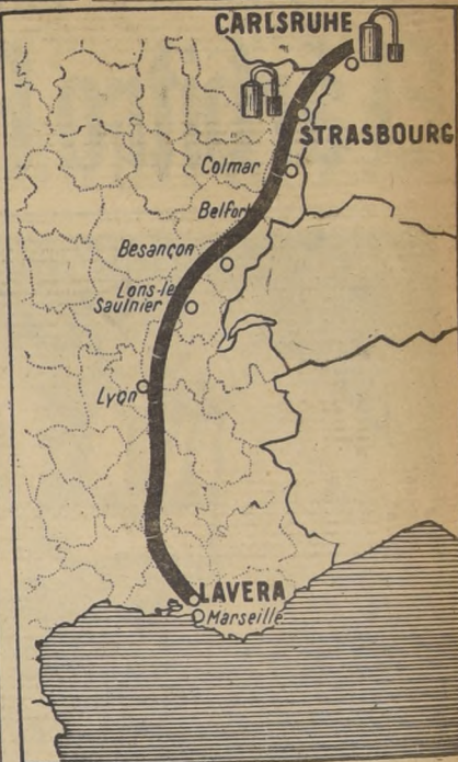
ESTE ES EL trazado del futuro pipeline que unirá el puerto petrolero francés de Laverne (cerca de Marsella) con Estrasburgo, con prolongación hacia Suiza y hacia Alemania hasta Carlsruhe. Esta obra deberá entrar en servicio a fin de 1962 y necesitará unas 118.000 toneladas de tubos soldados. El pipeline está destinado al transporte anual de 25 millones de toneladas de petróleo. Su costo de construcción ha sido estimado a 50 mil millones. Dos refineras serán construidas tanto en Estrasburgo como en Carlsruhe para tratar el petróleo transportado. (Foto S.F.I.)
