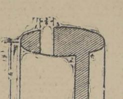
La figura superior muestra la forma en que se debe hacer los cortes en el tubo, y sus correspondientes dimensiones en pulgadas. En la figura de abajo se muestra la forma en que va el arrollamiento. En el sentido de las flechas.
