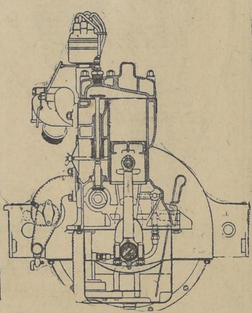
Corte vertical del nuevo "Motor 124", mirado de frente, en que se pueden ver las reformas principales de la lubricación a presión, cámara de combustión, carburador, ignición, etc.
