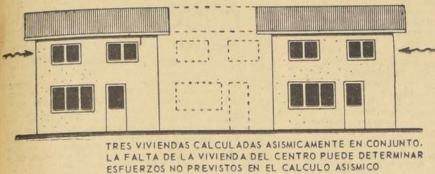
TRES VIVIENDAS CALCULADAS ASISMICAMENTE EN CONJUNTO. LA FALTA DE LA VIVIENDA DEL CENTRO PUEDE DETERMINAR ESFUERZOS NO PREVISTOS EN EL CALCULO ASISMICO
