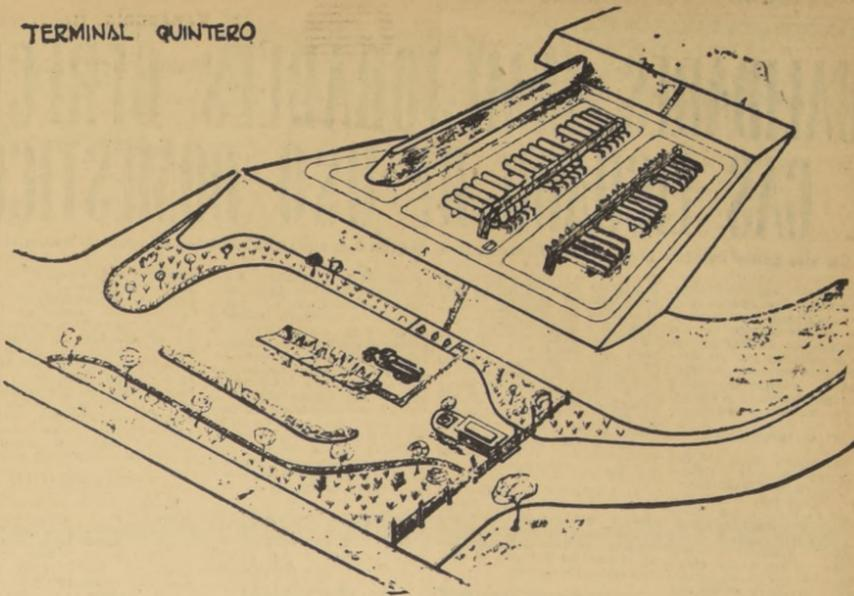
El terminal Quintero que está construyendo la ENAP en Quintero dispondrá de 30 estanques con capacidad para 120 mil litros de gas licuado cada uno. Los estanques se encuentran en una plataforma superior, según puede verse en el grabado y la plataforma inferior está destinada a los vehículos que cargarán el combustible para su distribución en la zona de Aconcagua a Linares.
