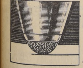
La bola tiene una superficie porosa que permite el paso de la tinta al punto así como alrededor del mismo
