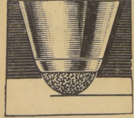
La bola tiene una superficie porosa que permite el paso de la tinta al punto así como alrededor del mismo
