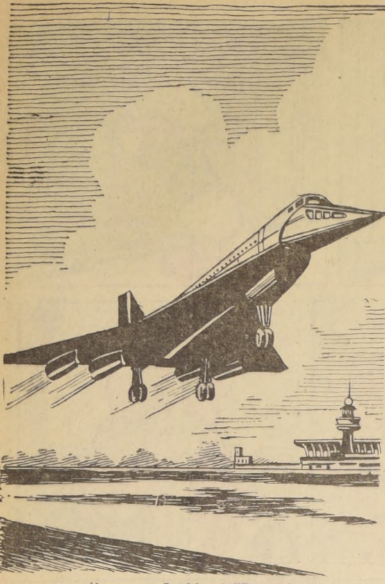
Como un gran pájaro, este Lockheed "Supersónico", baja la cola para retardar el aterrizaje, mientras la cabina de comando gira de punta para dar al piloto más visión de la pista.
