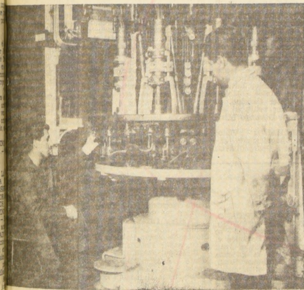
La extraordinaria unidad de fabricación automática de bulbos para ampolletas, dotada de 8 moldes rotatorios que producen 40.000 bulbos por día. Los operarios la llaman "carrousel".
