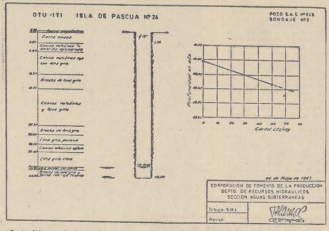
Corte del pozo de 45 metros de profundidad, realizado por la CORFO para proveer de agua potable a la Isla de Pascua. Proporciona 60 litros por segundo.
