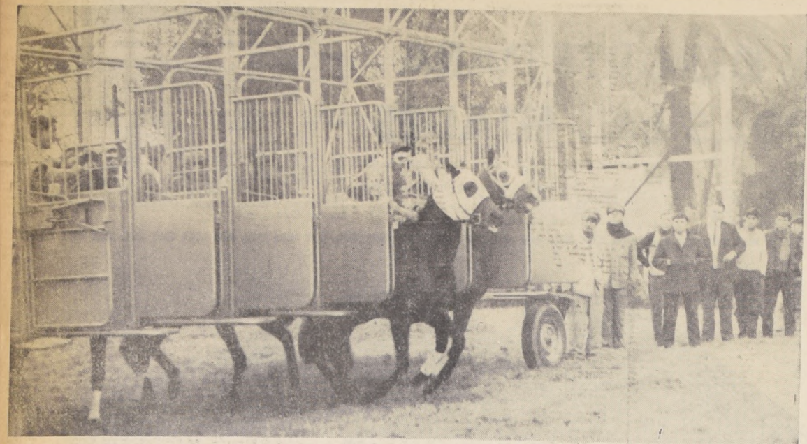
ebuto el partidor del Club Hípico. El sistema de puertas funcionó sin ningún problema. El nuevo aparato mecánico cimbra mucho y, además, hace demasiada ruidos. Da la impresión que fuera muy liviano. Notamos también que, a diferencia de otros partidores, éste no tiene protección para los participantes. La rra la ganó Enchapada, que partió adelante, con más experiencia en esto de los "partidores".
