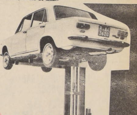
Instalación para elevación de automóviles, para estaciones de servicio.
