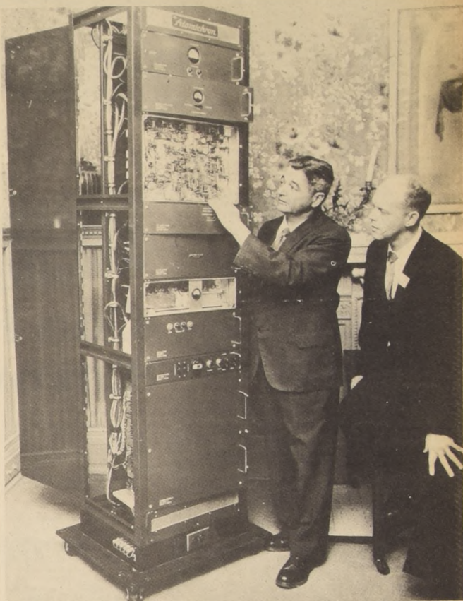
Un moderno reloj atómico recibirá el Departamento de Astronomía de la Universidad de Chile, en préstamo por 12 meses. El del grabado es un modelo "anticuado" de 15 años atrás, cuya variación alcanzaba un máximo de 5 segundos en tres siglos de marcha.
