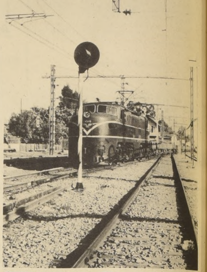
Modernas locomotoras italianas aseguran suficiente y rápido poder de tracción a los trenes de pasajeros y de carga, lo que se ha traducido en un servicio más cómodo para los usuarios. Por otra parte, el equipo eléctrico consume menos energía y demanda menos mantenimiento que el Diesel y el a vapor.
