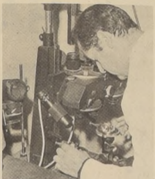
UN PERITO BALISTICO trata de identificar un proyectil balístico en el microscopio de clasificación
