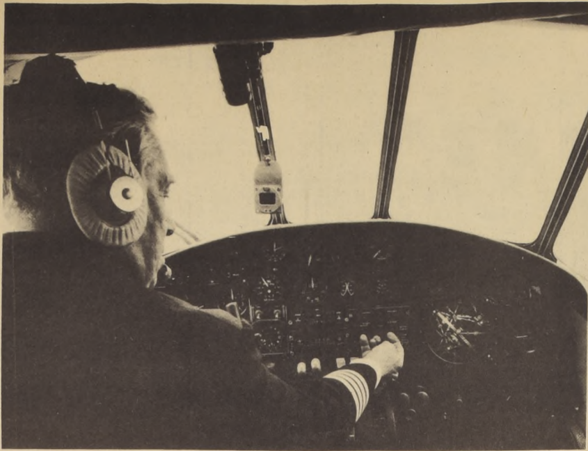
Primer plano del "mapa sin fin" de Marconi, instalado en la cabina de un avión. El aparato proyecta un mapa al detalle de la zona que sobrevuela el avión. De un vistazo, el piloto puede situar así su posición con respecto a la ruta o a su punto de destino.
