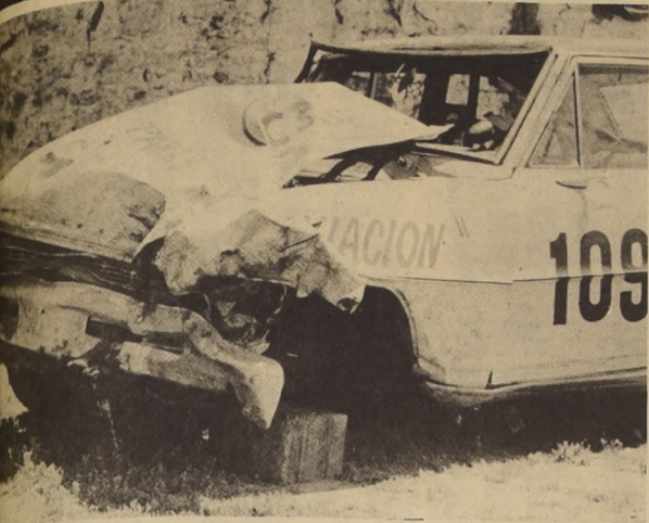
EL COCHE DE LA TRAGEDIA: el N° 109, que conducía Jorge Eduardo Mac Kay la colisión con un perro originó la cortadura del muñón de la rueda delantera izquierda, embistiendo a los espectadores.
