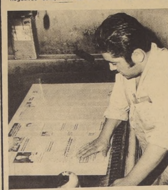
MEDIANTE UN PROCESO QUIMICO, las páginas pasan a la sección Revelado. Es aquí donde la imagen es transferida a las planchas.
