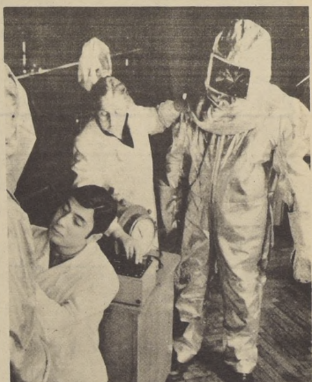
NUUEVO TRAJE NEUMATICO diseñado en el Instituto Científico URSS, en Tbilisi, para trabajar a 200 grados sobre cero. Pesa sólo dos y medio Kgr. y no dificulta los movimientos.
