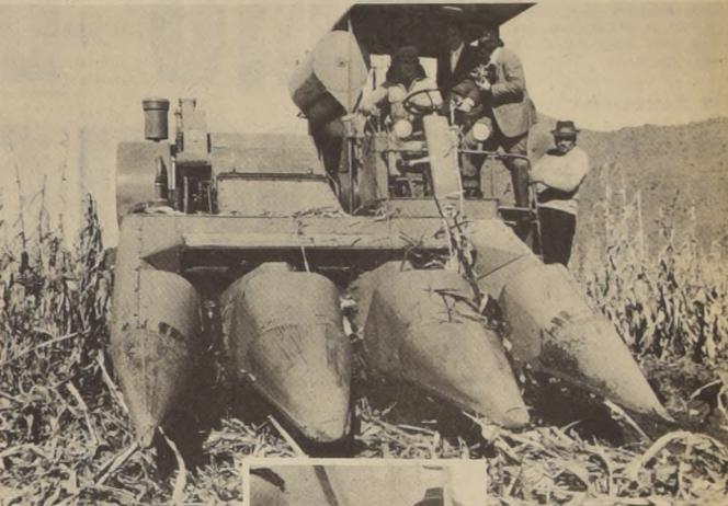
El nuevo cabezal maicero, de cuatro fauces, totalmente fabricado en Chile y diseñado por el Departamento Metal Mecánico de SERCOTEC, mostró su eficiencia en una plantación del Centro de Reforma Agraria "Juan Chacón Corona", de la comuna de Machali, del Departamento de Rancagua.
