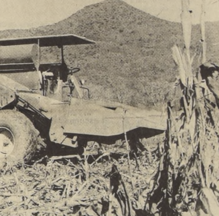
Después de un completo período de control y funcionamiento en el terreno, la CORFO recibió la primera máquina cosechadora de maíz. Esta máquina fue diseñada y construida por ingenieros y técnicos del Departamento Metal Mecánico del Servicio de Cooperación Técnica. La cosechadora, que vemos en la foto, forma parte de un programa elaborado por organismo de Gobierno, destinado a sustituir máquinas y elementos que se utilizan en la agricultura y que actualmente deben importarse.
