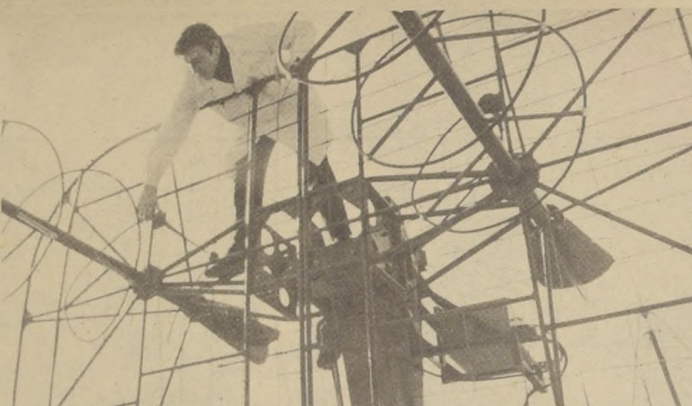
SINTONIZACION DE LA ANTENA para captar las señales de un satélite de la Tierra.
