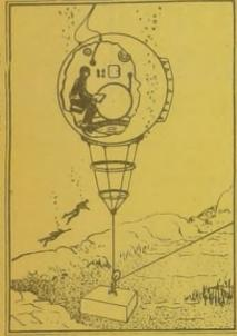
CAMARA DE DESCOMPRESION. Esfera de acero, de unos dos metros de diámetro, en la que pueden entrar cuatro buceadores por una escotilla de fondo, y tomar notas o comunicarse telefónicamente con la tripulación durante el lento proceso de descompresión.
