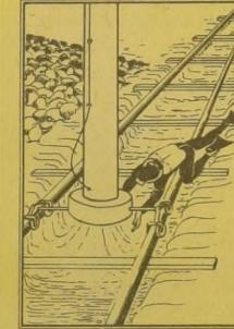
ELEVADOR POR AIRE. Se trata de un simple tubo a cuya extremidad inferior se bombea aire desde la superficie. Las burbujas de aire que ascienden por el tubo succionan el agua y la arena dejando al descubierto las partes enterradas de los restos. Pueden instalarse rieles que faciliten el manejo de este pesado aparato.
