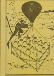
PORTADOR DE ANFORAS. Por lo general, las ánforas que se encuentran entre los restos de naufragios antiguos están llenas de barro y son difíciles de transportar. Una simple armadura sujeta a un globo inflado por medio de un tubo de aire puede remontar a la superficie hasta un peso de media tonelada.
