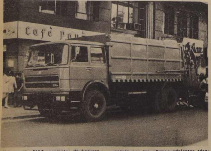
Un camión FIAT recolector de basuras, con tolva de 18 mts.3, se encuentra a disposición del Departamento de Aseo de la Municipalidad de Santiago, en demostración. Este camión, de fabricación argentina,
