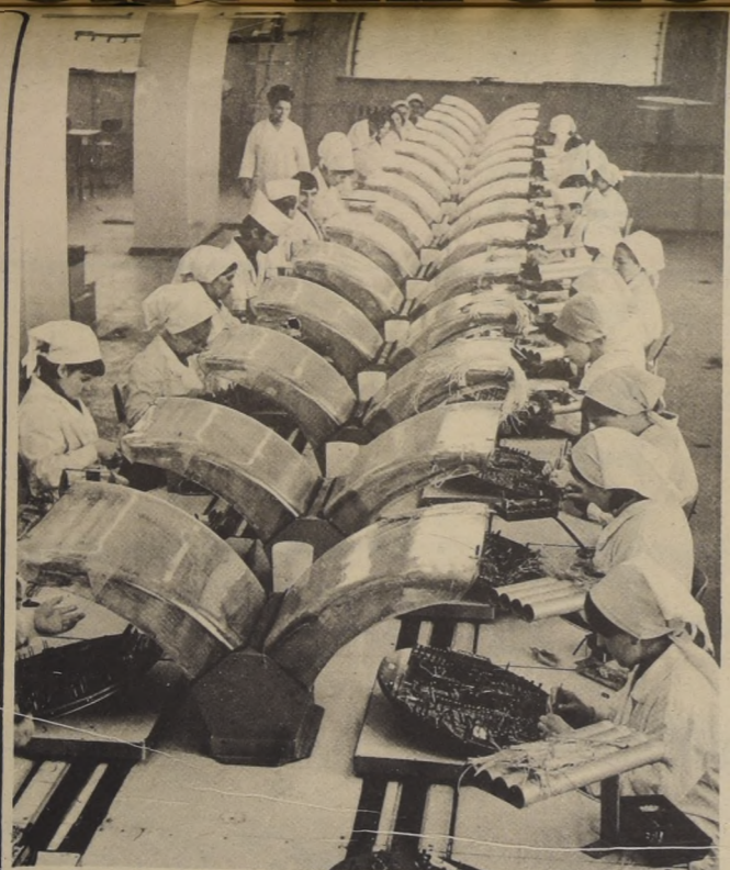
La cadena de montaje del magnetófono "Kometa MG-209" en la fábrica de maquinaria de precisión, Novosibirsk.
